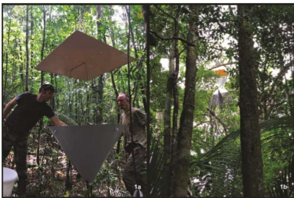
Exemple de piège lumineux automatique de canopée (développé en Guyane).
