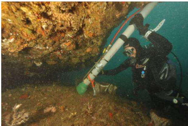
Aspirateur sous-marin Les sédiments bio-détritiques déposés sur les dalles rocheuses sont aspirés et recueillis dans un filet à maille fine
