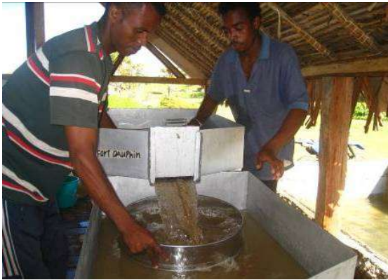
Au retour des récoltes le matériel est tamisé manuellement sur plusieurs mailles de tamis afin d'obtenir des classes de taille homogène.
