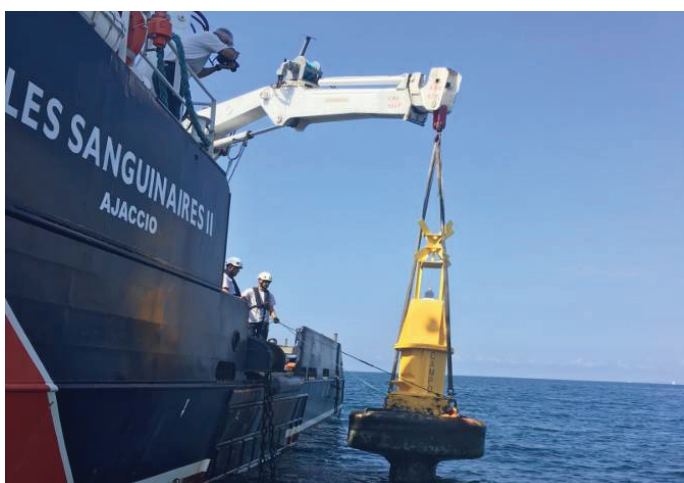
Corps mort éco-conçu pour les récifs artificiels
