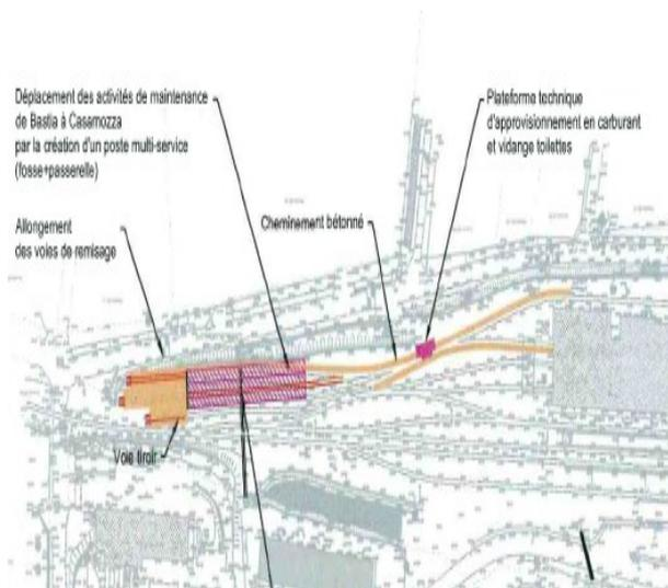
Il s'agirait de créer un nouvel atelier sur l'emplacement des voies de remisage situées au nord de l'atelier existant. Cet emplacement permettra d'avoir la flexibilité nécessaire au niveau de l'exploitation. Dans le même temps la voie terminus de navette actuelle de Casamozza sera relocalisée coté parking (transfert de la navette de la voie V3 sur la voie V4).
