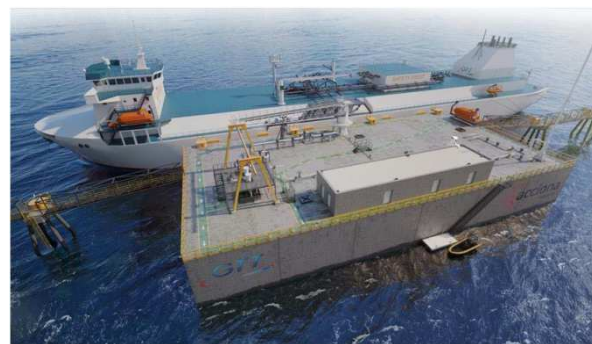
Exemple de GBS (16 000 m3, 4 m émergés)
