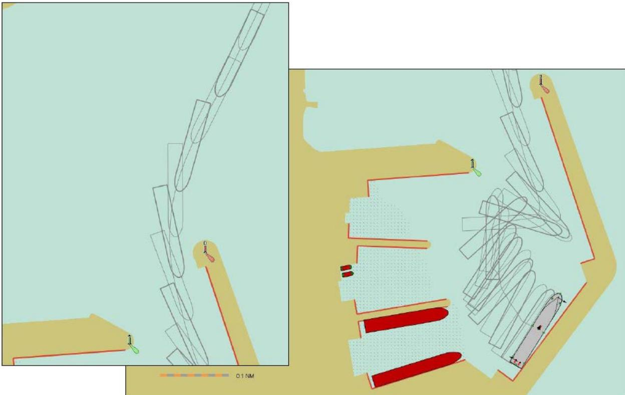
Essais d'accostage poste 7 RoPax 225m par Houle N 45°/7s/1,2m ; vent 10m/s N45°
