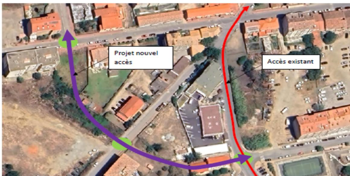
*Figure 6 - tracé de la voie de contournement projetée*
