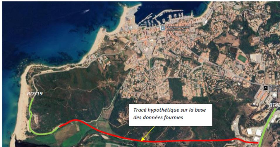
Figure 3 - Projet de tracé pour le contournement du centre-ville de Prupia et accès au port
