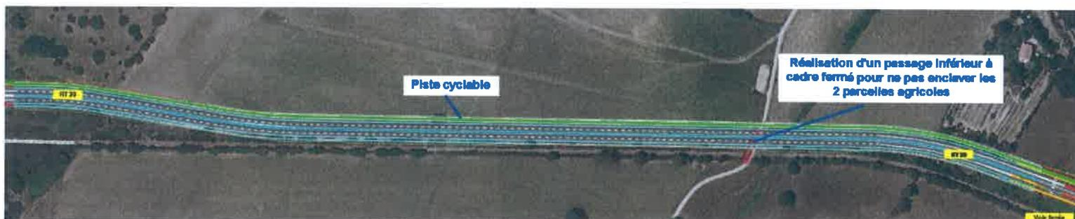
Afin de ne pas enclaver deux parcelles agricoles et d'éviter un accès direct à des engins agricoles sur la 2x2, il est prévu de réaliser un passage inférieur à cadre fermé (PICF).
