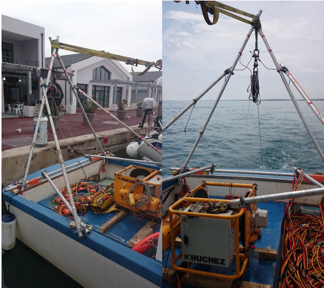
Figure 13. Illustration du portique supportant la poulie compteuse et du treuil permettant d'ajuster en continu l'altitude du dispositif au-dessus du fond
