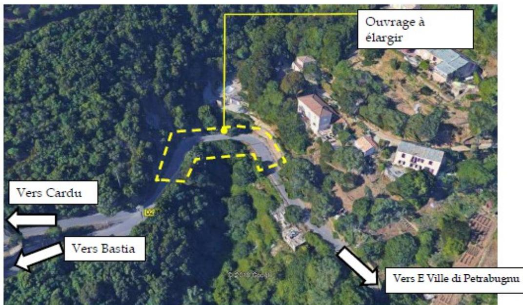
Le projet initial prévoyait l'élargissement de cet ouvrage par l'amont, incluant la confection d'un trottoir. Du fait de la présence d'amiante environnemental, les terrassements pour l'élargissement de cet ouvrage côté amont sont compliqués et onéreux à réaliser, avec notamment un problème de stockage des volumes excédentaires de déblais amiantifères.
