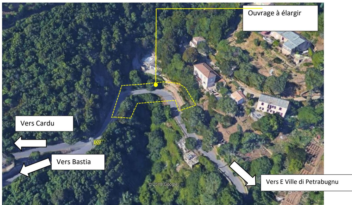
**Le projet initial prévoyait l'élargissement de cet ouvrage par l'amont, incluant la confection d'un trottoir. Du fait de la présence d'amiante environnemental, les terrassements pour l'élargissement de cet ouvrage côté amont s'avèrent complexes et onéreux à réaliser, avec notamment un problème de stockage des volumes excédentaires de déblais amiantifères.**
