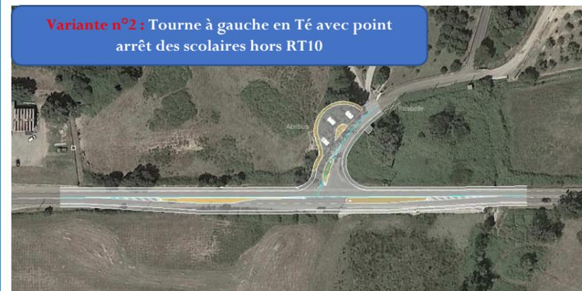
La variante la plus plébiscitée est la variante n°2, dans laquelle la Direction des Investissements Routiers Cismonte de la Collectivité de Corse propose la création d'un tourne à gauche de type carrefour en té, avec voie de stockage et ilots. Cet aménagement sécurise les entrées/sortie de la RT10 vers Valle Longhe et améliore la lisibilité carrefour pour ses usagers.
