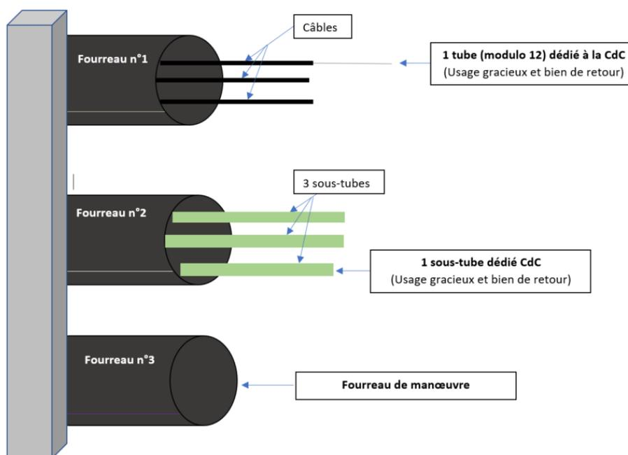
Pour les sections ne comportant que 1 ou 2 fourreaux, le Délégué fait son affaire du fourreau de manœuvre par la mobilisation d'un sous tube à déployer sans remettre en question le principe du sous tube réservé au Délégué.
