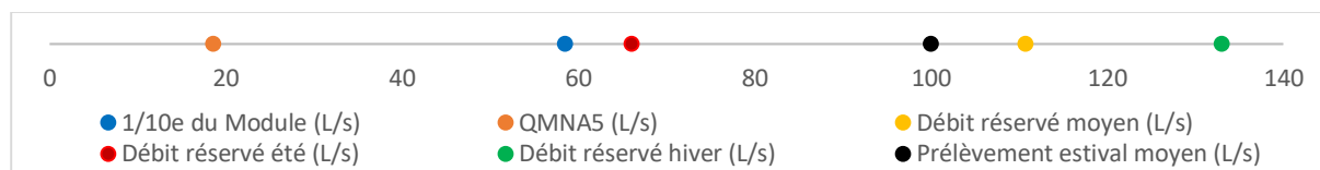
Figure 60 : Répartition du 10 e du module, du QMNA5, du débit réservé et du prélèvement estival moyen pour le barrage de l'Ortolu
