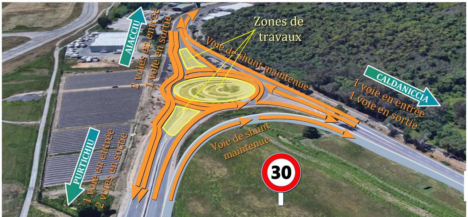
Pendant cette phase sont construites les rampes de part et d'autre du futur rond point, qui permettront de descendre dans la trémie. Les travaux sont de même nature que ceux réalisés au centre du rond point : battage de palplanches métallique, creusement des trémies, réalisation des radiers et parois en béton armé.
